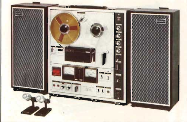
Drei Köpfe, drei Geschwindigkeiten, professionelles Tonbandgerät. Eingebauter Stereoverstärker. Funktioniert unabhängig als Bandaufnahmeanlage, Verstärker und Tonbandgerät. 3 Köpfe: Aufnahme, Wiedergabe und Löschen. Komplette Stereo-Anlage mit Eingängen für Mikrophon, Plattenspieler, Radio und "auxiliary". Ausgangsleistung 40 Watt (20 Watt je Kanal). Vormagnetisierung mit 160 kHz. Echo und "sound-on-sound"-Aufnahme. 2 VU-Meter, Rauschabblendung. Bandreiner. Bandzählwerk mit Knopf für 0-Stellung. Volumenkontrolle und Aufnahmeknopf für jeden Kanal. Automatische Bandendabschaltung und Pausenschalter. 2 angepasste Lautsprecher. Anschlüsse für externe Lautsprecher mit Wahlschalter. 2 Kopfhöreranschlüsse. Mithören auf einem oder mehreren Tonniveaus. Lässt sich auf verschiedene elektrische Spannungen anschließen. Vertikal und horizontal einsetzbar. Zubehör: Mikrophon F-26, SONY vorab aufgenommenes 12 cm Band, SONY-Leerspule R-7A, Verbindungskabel RK-74, Kopfreinigungsband, Spulenkappe.
